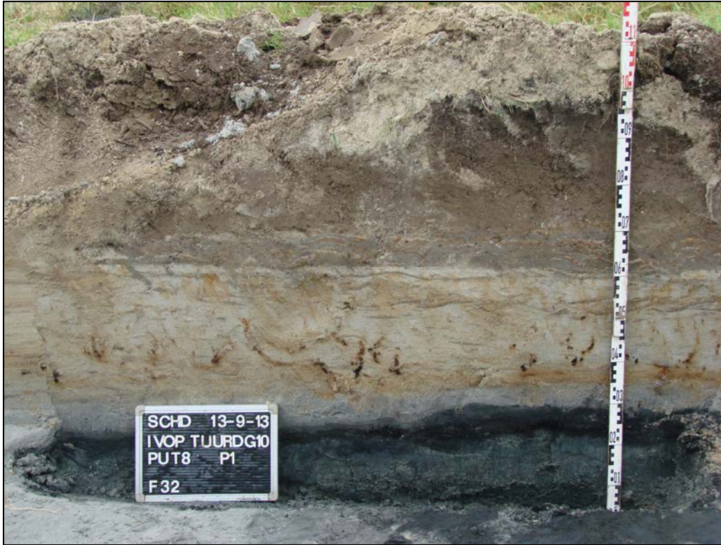
Afbeelding 21. Profielkolom nr. 1 van Proefsleuf nr. 8. De Afzettingen van Duinkerke (zand, grijs), op een verteerde graszode (zwart, oud maaiveld) op de vulling van moerneringsputten (pas zichtbaar onder het vlak). Foto nr. 32 (DSCO1514).
